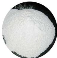
Magnesio idrosilicato di struttura lamellare micronizzato con precedente processo di sterilizzazione. Grazie alla sua finezza e bianchezza è particolarmente consigliato per l'uso in pitture e rivestimenti.
